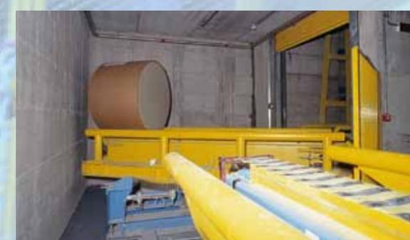
Nel 2001 La SICMA S.p.A. ha fornito per conto delle Cartiere Burgo S.p.A., presso lo stabilimento di Verzuolo, il sistema di movimentazione ed il magazzino automatico in grado di stoccare i rotoli in uscita dalle Macchine Continue MC8 e MC9. Il sistema comprende tutti i macchinari impiegati per: trasportare i rotoli provenienti dalle Macchine Continue, stocarli in un magazzino automatico, riprenderli in uscita dal magazzino a livello zero e movimentarli fino alla zona
