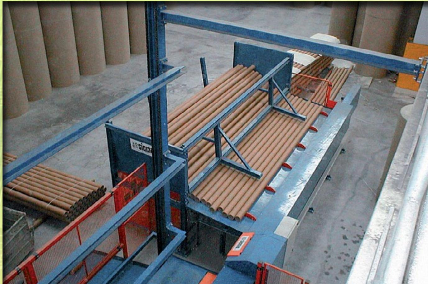
Il taglio viene azionato mediante la pressione contemporanea di due pulsanti sul pannello di controllo: il carter si chiude automaticamente ed il taglio dell'anima avviene in condizioni di totale sicurezza. La macchina include il gruppo di aspirazione delle polveri.
