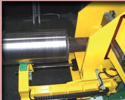
Questo tipo di impianti, completamente automatizzati e gestiti tramite un PLC, sono generalmente composti da un estrattore a catene, che estrae l'albero quando la levata è appoggiata sulle culle di ricezione in posizione bassa.
