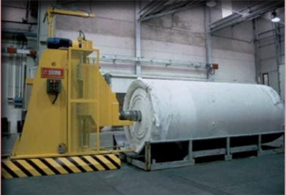
Ultimata l'operazione di inserimento, il dispositivo di fissaggio si disinserisce e permette a due bracci di prelevare l'albero con le anime di cartone per depositarlo nello stoccaggio.
